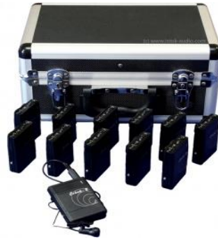
FM- система, беспроводное устройство позволяющее передавать звуковой сигнал от источника непосредственно на слуховой аппарат или кохлеарный имплант с помощью радиосигнала
